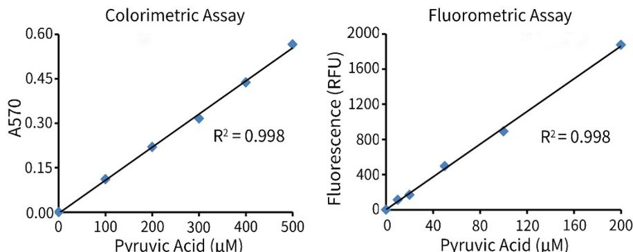
图2. 碧云天Amplex Red丙酮酸检测试剂盒(S0299)检测丙酮酸标准品的标准曲线。左图为吸光度检测, 右图为荧光检测。本试剂盒采用吸光度检测时, 在10-500μM浓度范围内有良好的线性关系; 采用荧光检测时, 在1-200μM浓度范围内有良好的线性关系。实际检测数据会因实验条件、检测仪器等的不同而存在差异, 图中数据仅供参考。
